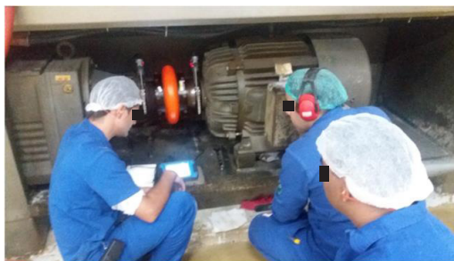
Figura 9. Técnicos realizando o alinhamento a laser, uma técnica da Preditiva.
