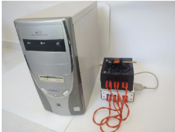
Figura 6. Interface de controle ligada ao computador e ao canhão de Gauss.
